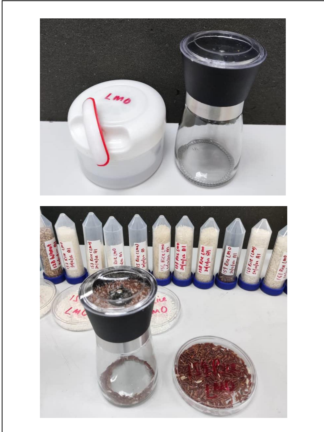
Rajah 4.1. Alat pengisar yang digunakan untuk penyediaan sampel
